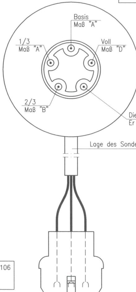
Die Stabsonde M 400 ist für Tankhöhen von 150mm bis 400mm verwendbar.
