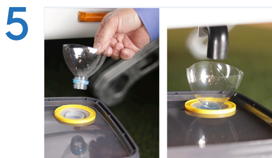
5 Als de afvoerbuis te ver boven de invoer opening blijft kun je dit oplossen met een trechter. Deze maak je eenvoudig zelf, zo hoog als nodig, van een PET fles.
